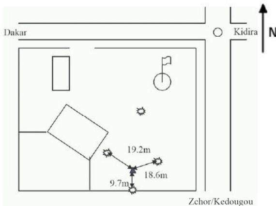
**Matérialisation** : Repère laiton grand modèle, scellé dans un tube pvc ancré dans un massif béton
