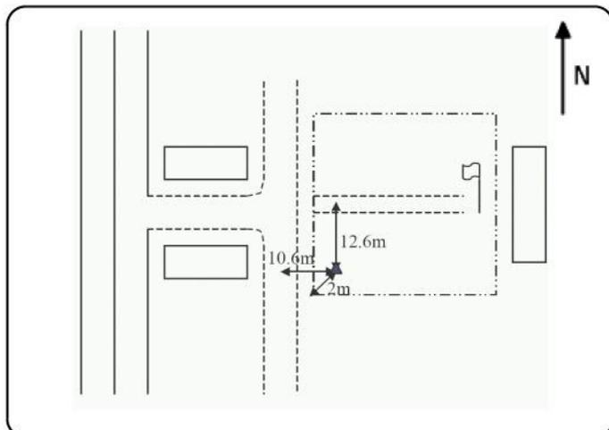
**Matérialisation** : Repère laiton grand modèle, scellé dans un tube pvc ancré dans un massif béton
